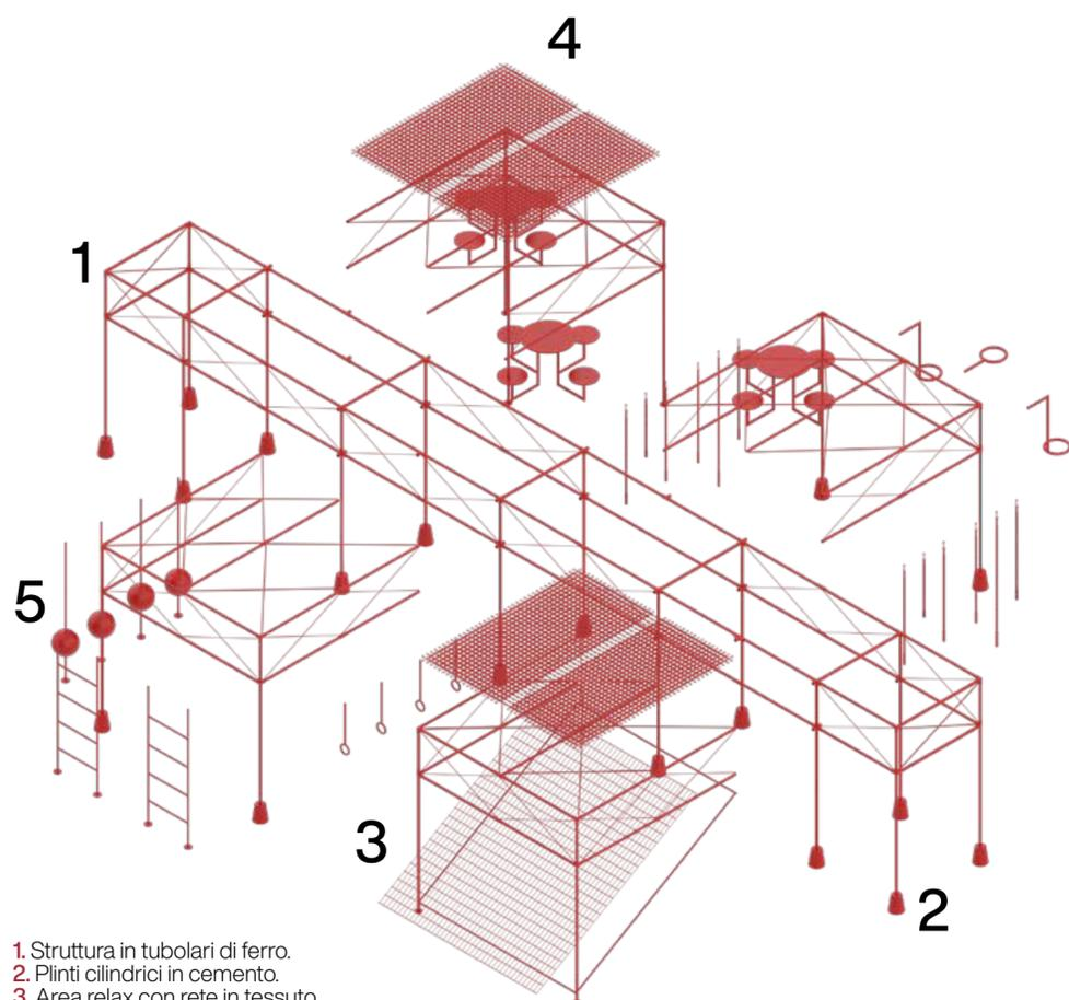
1. Struttura in tubolari di ferro.
